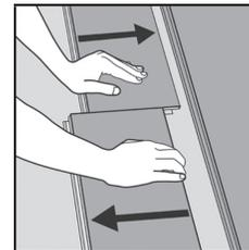
2. Désassemblez les planches les unes des autres en les glissant horizontalement. (Ne pas soulever les planches pour les séparer.)
