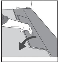
8. Enclenchez et frappez doucement la cale de frappe, afin de faciliter l'enclenchement et le verrouillage du joint (long) entre des morceaux de rangées parallèles. Faites ceci à plusieurs endroits le long du joint.
