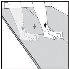
9. Pressez ou frappez doucement, le long des joints d'extrémité, une fois les planches installées.
