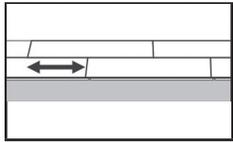
6. Les joints d'extrémité de planches adjacentes ne doivent pas être à moins de 16 po de l'un et l'autre.
