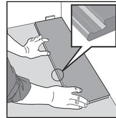
1. *Première planche de la première rangée :* Installez la première planche, (languette contre le mur) et laissez un joint d'expansion de 1/4 po le long du mur.
