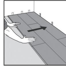
10. Après deux à trois rangées, ajustez au besoin l'espace entre le mur de départ et le plancher, afin de conserver un joint d'expansion de 1/4 po.
